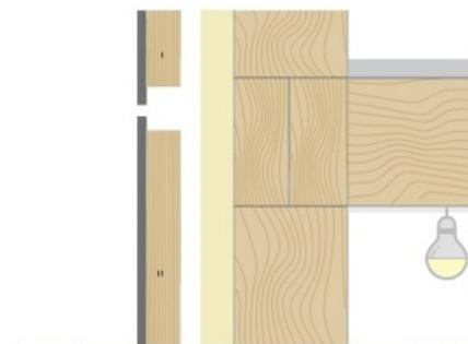
Рисунок 19: Соединение для горизонтального движения
