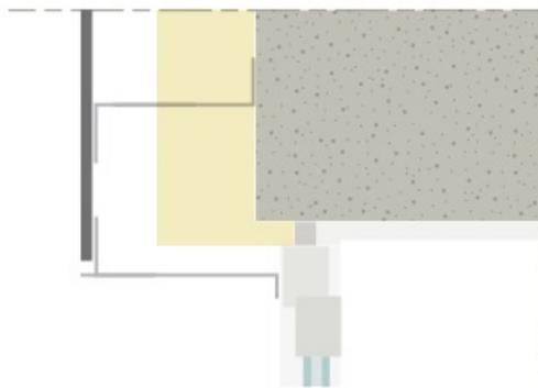
Рисунок 16: Оконная перемычка
